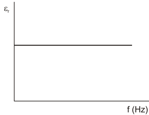
Obr. 5.9 Frekvenčná závislosť relatívnej permitivity iónových kryštalických látok
